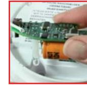
Die Rauchwarnmelder Ei650W und Ei650C lassen sich schnell und einfach mit Funkmodulen aufrüsten. Das Funkmodul wird einfach per Hand eingeklickt.
